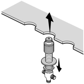
**2** Slide the gasket over the shank and handtighten the escutcheon. Faire glisser la rondelle par-dessus le manche et serrer l'applique à la main. Deslice el empaque sobre el vástago y apriete a mano el chapetón.
