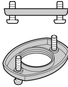
**9** Apply plumbers putty to the underside of the valve bonnets. Appliquer du mastic de plombier sur le dessous des capuchons de la valve. Aplique masilla de plomería al lado inferior de los bonetes de válvula.
