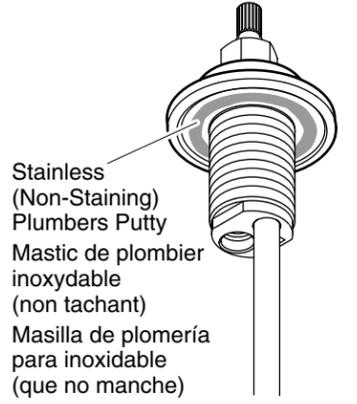
**10** Insert the "COLD" valve on the right and the remaining valve on the left. Insérer la valve "COLD" (Froid) sur la droite et l'autre valve sur la gauche. Inserte la válvula identificada como "COLD" en el lado derecho y la otra válvula en el lado izquierdo.
