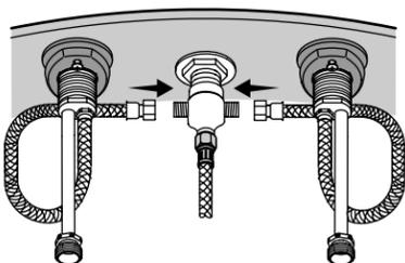
**16** Remove the aerator and connect the water supplies. Retirer l'aérateur et connecter les alimentations d'eau. Retire el aireador y conecte los suministros de agua.
