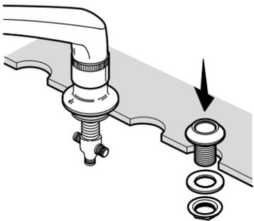
**7** Insert the sidespray and connect the hose to the spout. Insérer le vaporisateur latéral et connecter le tuyau au bec. Inserte el rociador lateral y conecte la manguera al surtidor.
