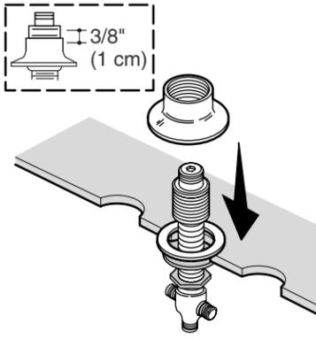
**3** Thread the spout completely onto the shank. Visser entièrement le bec sur le manche. Enrosque el surtidor completamente al vástago.
