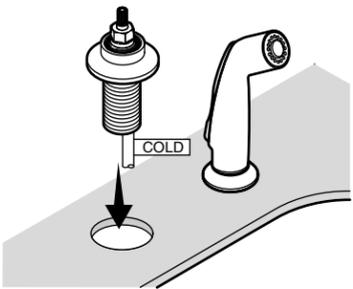
**11** Loosely secure each valve with a washer and a threaded ring. Fixer chaque valve avec une rondelle et un anneau fileté, sans serrer. Fije sin apretar cada válvula con una arandela y un anillo roscado.
