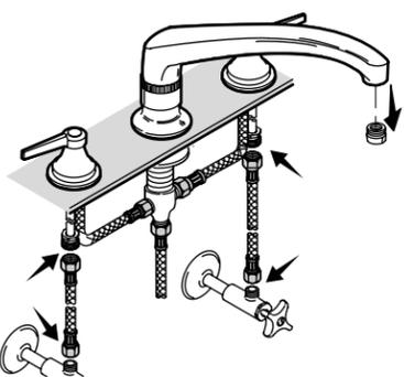
**17** Turn on the water supplies. Check for leaks. Ouvrir les arrivées d'eau. Vérifier s'il y a des fuites. Abra los suministros de agua. Verifique que no haya fugas.
