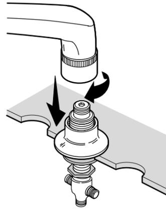
**4** Thread the escutcheon up until snug against the spout. Tighten the nut on the shank. Enfiler l'applique vers le haut jusqu'à ce qu'elle soit à ras du bec. Serrer l'écrou sur le manche. Enrosque el chapetón hasta que quede justo contra el surtidor. Apriete la tuerca al vástago.
