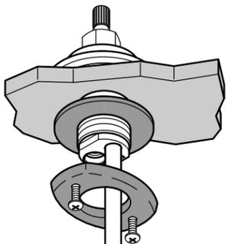
**12** Position the screws to the front and back and tighten to secure. Placer les vis sur l'avant et l'arrière et serrer pour fixer en place. Coloque los tornillos en el frente y atrás y apriete para fijar.
