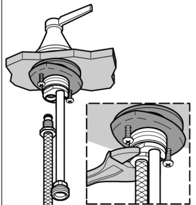
**15** Connect the hoses to the tee. Do not overtighten! Raccorder les tuyaux au T. Ne pas trop serrer! Conecte las mangueras a la T. ¡No apriete demasiado!
